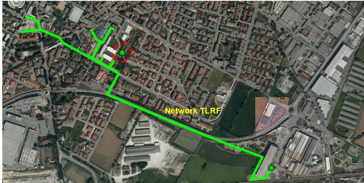
La rete è una soluzione a 2 tubi (1,2 MW - 2,3 km) operata alla temperatura dell'acqua di pozzo (circa 15 ° C).
