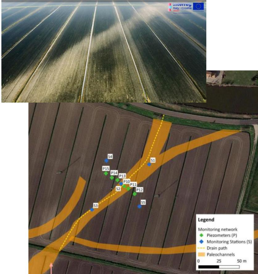
Inserimento lungo un paleoalveo sabbioso di un dreno lungo 200 m e profondo 1.5 m con cui distribuire acqua dolce prelevata da un canale consortile
