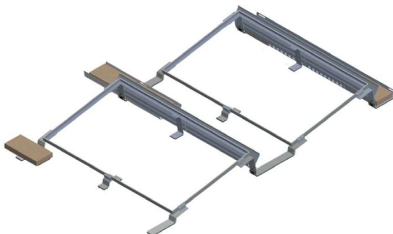
Figura 10 Schema di struttura di supporto dei pannelli senza fondazione
